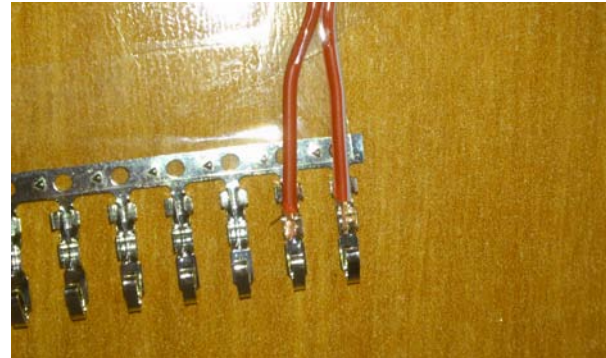
Kabel bis zur Mitte einlegen und fixieren
